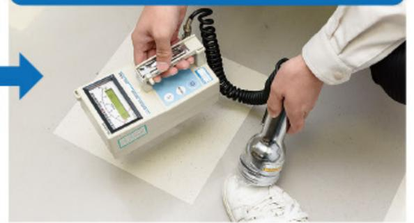
シンチレーション式サーベイメータは、身の回りの空間放射線量率を測定したい場合に使用します。 $\mu\text{Sv/h}$ (マイクロシーベルト/毎時)の単位で表示され、一時間その場所にいた場合の放射線量を表しています。GM管式サーベイメータは、付着した放射性物質から出る放射線(主にベータ線)の数を検出し、衣服などの汚染度合を調べるためのものです。単位はcpm(シーピーエム:カウント/毎分)が使われ、1分間あたり計測された放射線の数で表示します。
