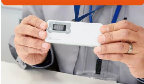
携帯して周囲の空間放射線量率を測定することができます。空間線量率を合計した値(積算線量と言います。単位はミリシーベルトです。)を測定することもでき、空間線量率と積算線量の測定データは、本体の表示部で確認することができます。
