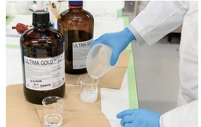
※シンチレータとは放射線エネルギーにより発光(蛍光)する物質のことをいいます。トリチウム測定試料は水としての形が多いため、保水量の多い乳化シンチレータが使われています。
