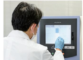
トリチウムは弱いベータ線しか放出しないため、直接放射線を測定することが難しくなっています。放射線が当たると微弱な光を発する液体のシンチレータを測定対象物に添加し、シンチレータからの光量を測定することにより、トリチウム放射能を評価します。
