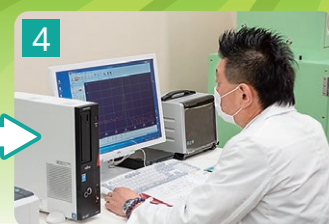
試料名や採取場所、測定時間、試料量等の条件を入力して、放射性物質濃度の測定を行う。
