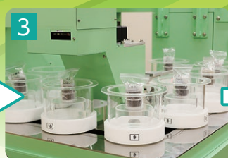
ゲルマニウム半導体検出器にセットする。
